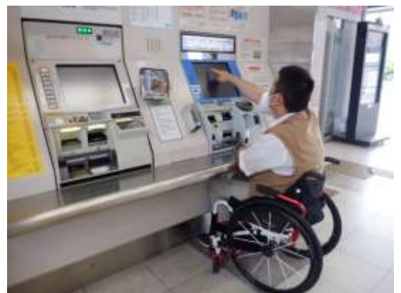
券売機 車いす利用者には設置位置が高い。
